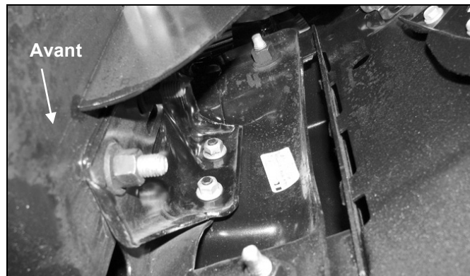
(Fig 2) Éléments de fixation du crochet de remorquage vus depuis l'arrière du côté droit/passager du pare-chocs
